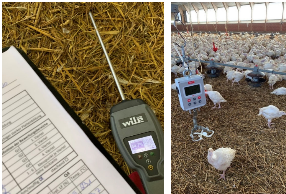
Abb. 13: Messtechnik zur Erfassung der Einstreufeuchte und -temperatur (links) und der Tiergewichte (rechts).
